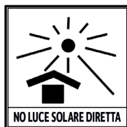
Fig. 5.1 - Non esporre alla luce solare diretta, campo di temperatura 0° - 50°C, installare su un terreno piano e uniforme.
