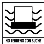
Fig. 5.1 - Non esporre alla luce solare diretta, campo di temperatura 0° - 50°C, installare su un terreno piano e uniforme.
