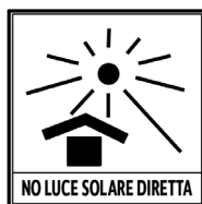
Fig. 3.1 - Non esporre alla luce solare diretta, campo di temperatura -20° - 55°C, installare su un terreno piano e uniforme.
